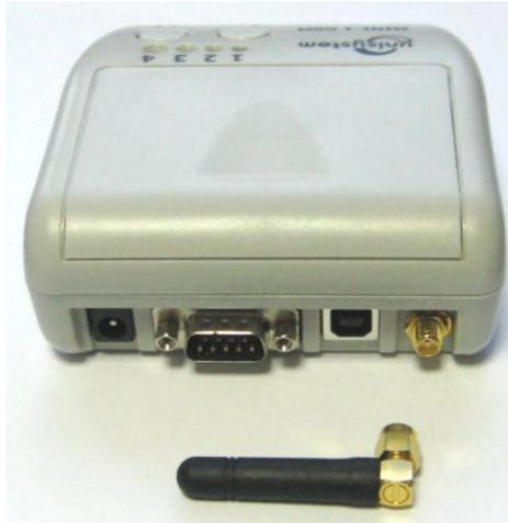
2. Аккуратно прикрутить антенну по часовой стрелке к антенному разъему на интерфейсной панели.
