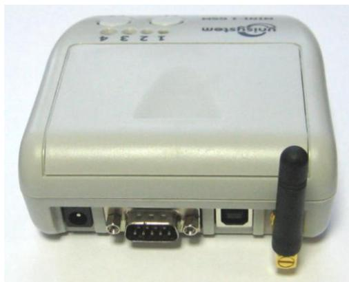
3. При плохом сигнале связи можно использовать выносные антенны. Выносная антенна в комплект поставки не входит и при необходимости должна приобретаться отдельно. Установка выносной антенны производится аналогичным образом.
